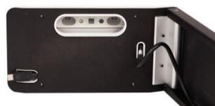
Compact 6 HD Speech è posizionato correttamente quando la telecamera e le luci sono allineate con le finestre sul lato superiore.
