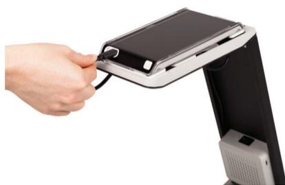
Inserisci il cavo USB del piano di supporto nella porta USB del Compact 6 HD Speech per caricare il dispositivo e collegare l'altoparlante.
